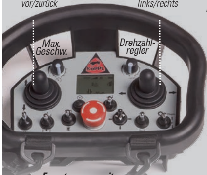
Fernsteuerung mit ca. 300 m Reichweite und Display
